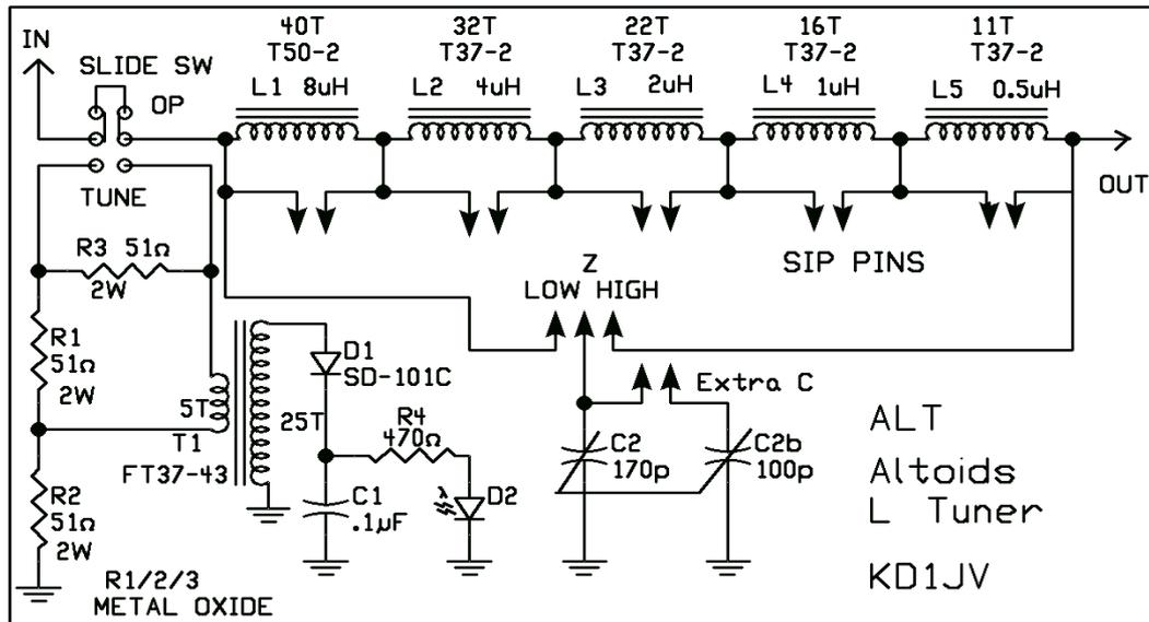
Este diseño es obra de KD1JV, prolífico autor de equipos para radioaficionado. Usando su descripción de un acoplador en L para antenas de media onda alimentadas por un extremo (alta impedancia) decidí construir un acoplador para usarlo con mi FT817.
