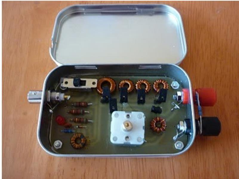
El acoplador está diseñado para ser usado con hilos largos, **pero siempre es necesario añadirle una contraantena**. Se puede usar en las bandas entre 40 y 15 metros.
