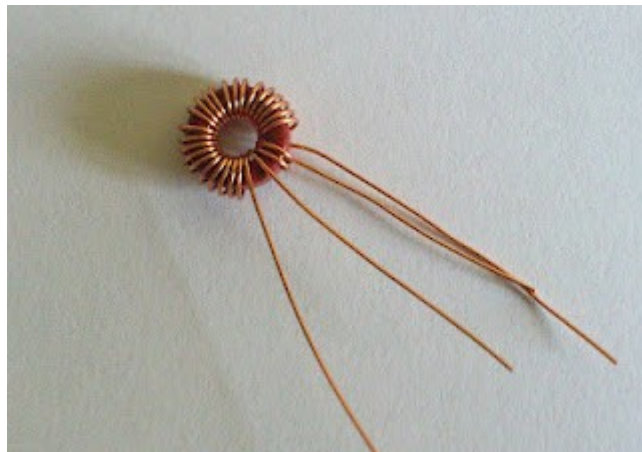
Vstupní transformátor TR1
