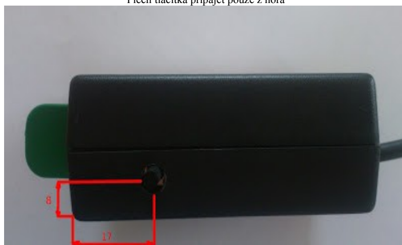
Plech tlačítka připájet pouze z hora
