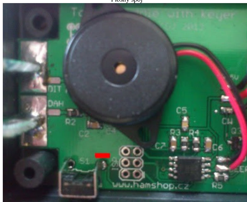
Plech tlačítka připájet pouze z hora
